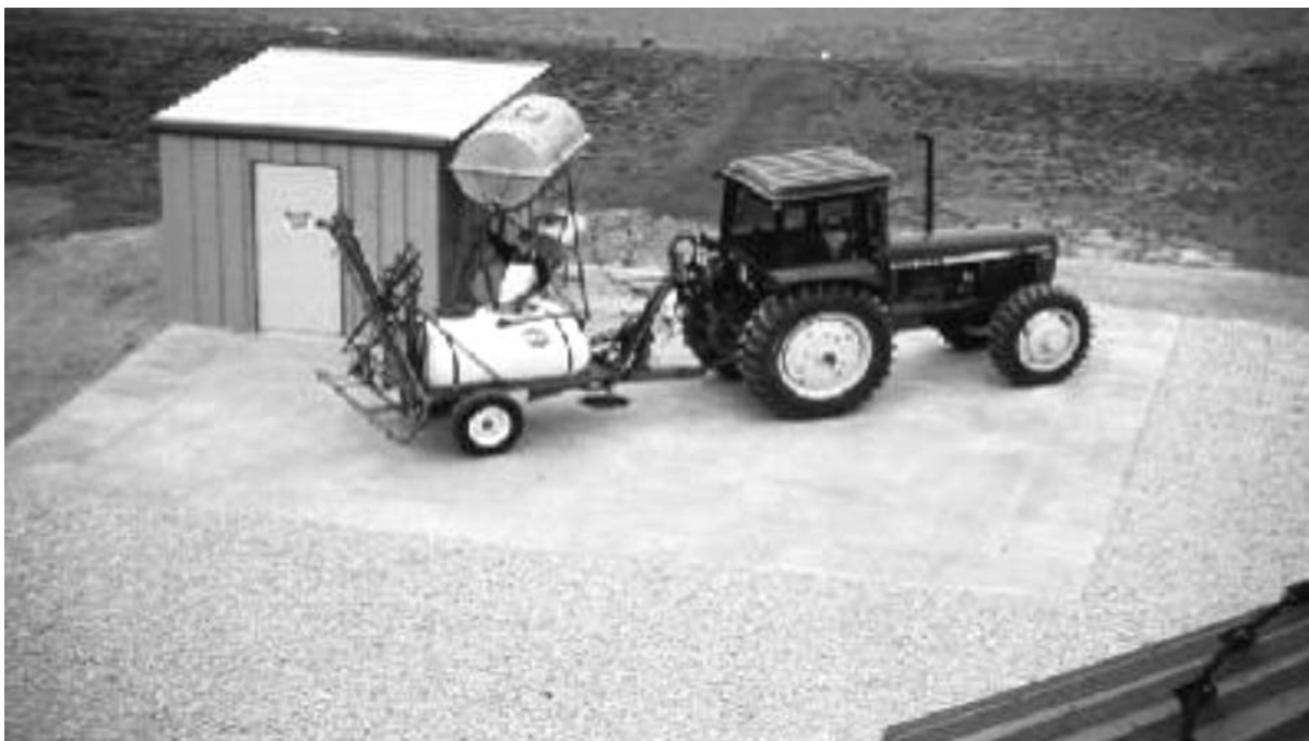
Figura 14.1. Centro de cargas de equipos pulverizadores
