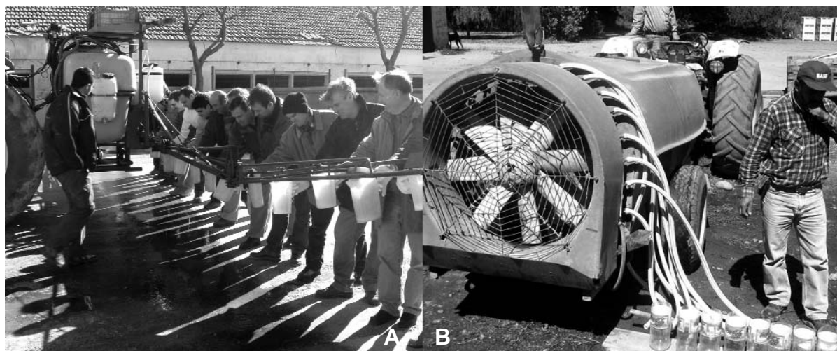
Figura 10.1: A) Regulación de una máquina pulverizadora de barras; B) Regulación de un equipo pulverizador hidroneumático para frutales
