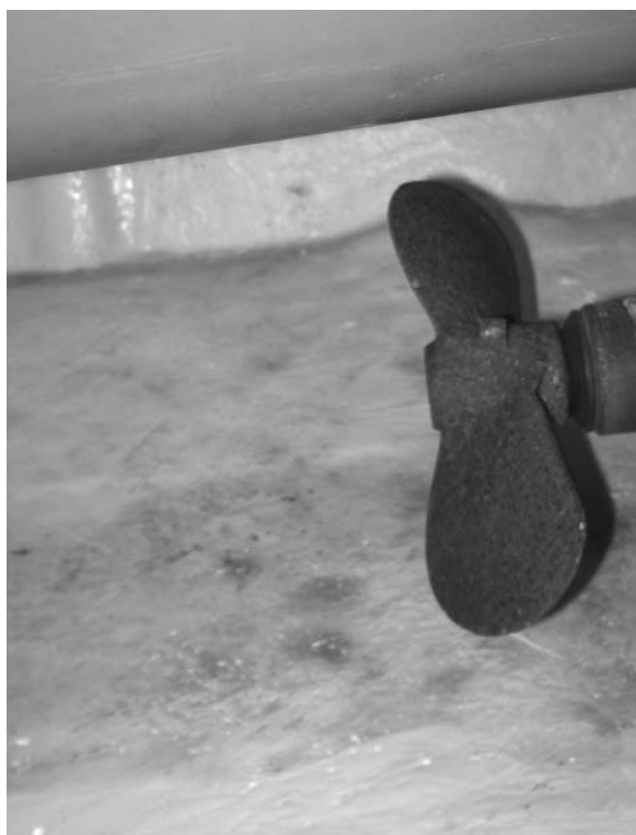
Figura 9.4. Sistema de agitación mecánico con hélice
